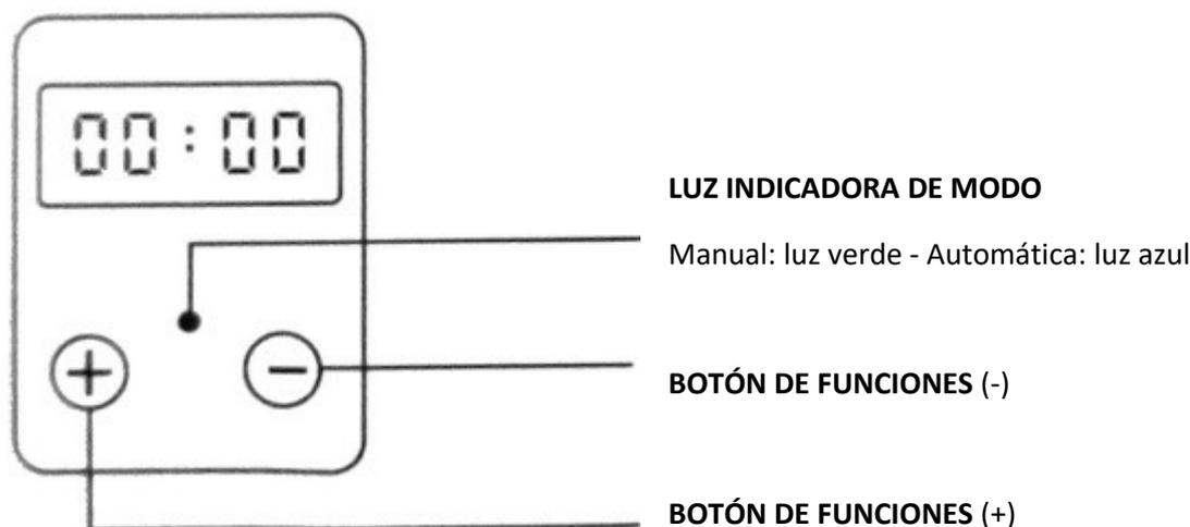
1. Abra el compartimento de las baterías que se encuentra en la base del dispenser y colóquelas (no incluidas). Conecte el cable USB a la corriente y al comedero. Luego de la conexión, el display numérico se iluminará y mostrará 00:00. (**NOTA:** utilice solo el cable USB incluido en el producto para evitar desperfectos. Las baterías necesarias para este dispenser son 4 AA no incluidas. Se recomienda utilizar ambos modos de suministro eléctrico a la vez)
