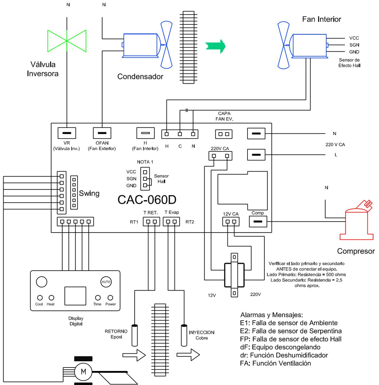
NOTA 1: En caso que el motor que posea NO tenga sensor de efecto Hall o esté dañado, para eliminar la alarma puede realizar un puente entre SGN y GND
